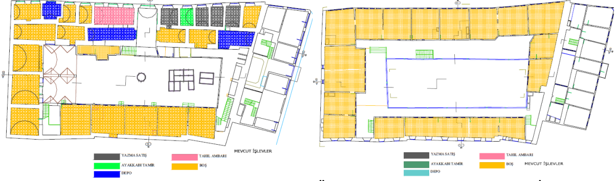
Şekil 23. Yazmacılar Hanı'nın Restorasyon Öncesi Zemin Kat ve Birinci Kat İşlevleri (Kaplan, 2007)
