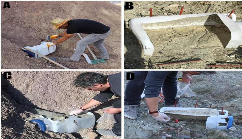
Fotoğraf 1 Yamaç Eteklerine Taşınan Sedimanın Miktarı, Şekil ve Boyutlarının Tespiti Amacıyla Kurulan Sediman Tuzaklama Yöntemi. (A) Sediman Tuzaklama Kurulumu, (B) Kurulan Tuzakta Biriken Sediman, Güney (C) ve Kuzey (D) Yamaçlardaki Tuzaklarda Biriken Sedimandan Toplanan Örnekler
