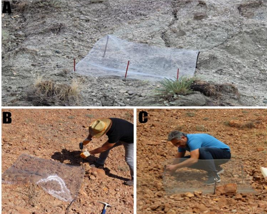
Fotoğraf 3 Yamaç Erozyonunun Şiddetinin Belirlenmesi Amacıyla Kurulan Ağ (A), Ağ Kurulumun (B) ve Biriken Sediman Örneklerinin Alınma Aşamasından (C) Birer Görünüm.
