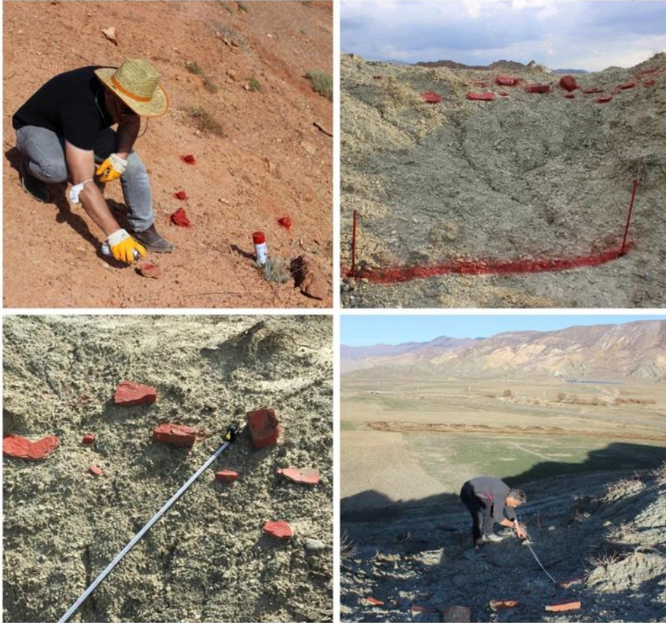
Fotoğraf 2 Yamaçlarda Eğim, Yağışın Şiddeti ve Süresine Bağlı Olarak Taşınan Çakıl ve Blok Boyutundaki Sedimanın Taşınma Mesafesinin Ölçümü ve Daha Küçük Boyutlu Sedimanlara Gömülme Durumunu Belirlemek için Uygulanan Boyalı Taş Yöntemi
